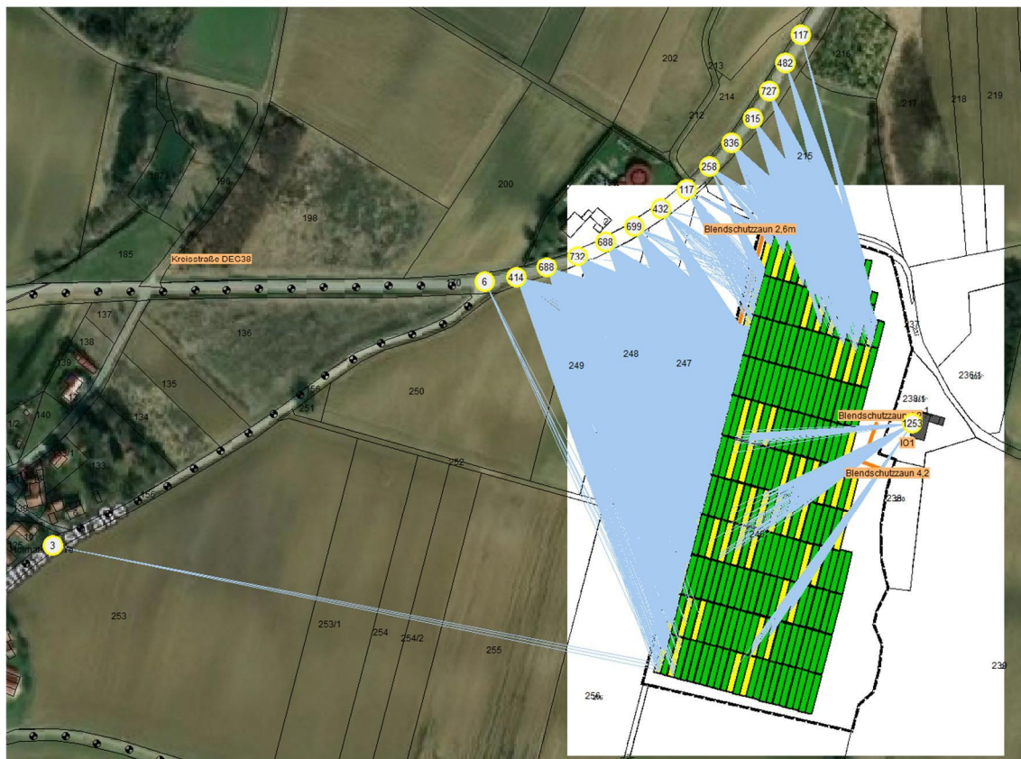
Abbildung 5.4: Ost-West-Ausrichtung mit Blendschutzzaun mit Ergebnissen (gelb \leq 1800 , rot > 1800 ) und Richtung der Blendung (hellblau)
