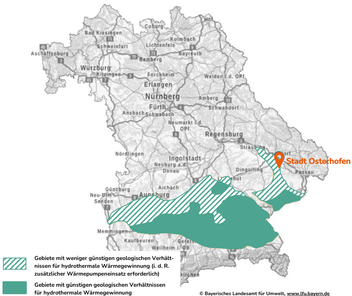
Abbildung 35: Tiefe Geothermie - Gebiete für Wärmegegewinnung in Bayern [Datenquelle: Bayerisches Landesamt für Umwelt, www.lfu.bayern.de und eigene Ergänzungen]
