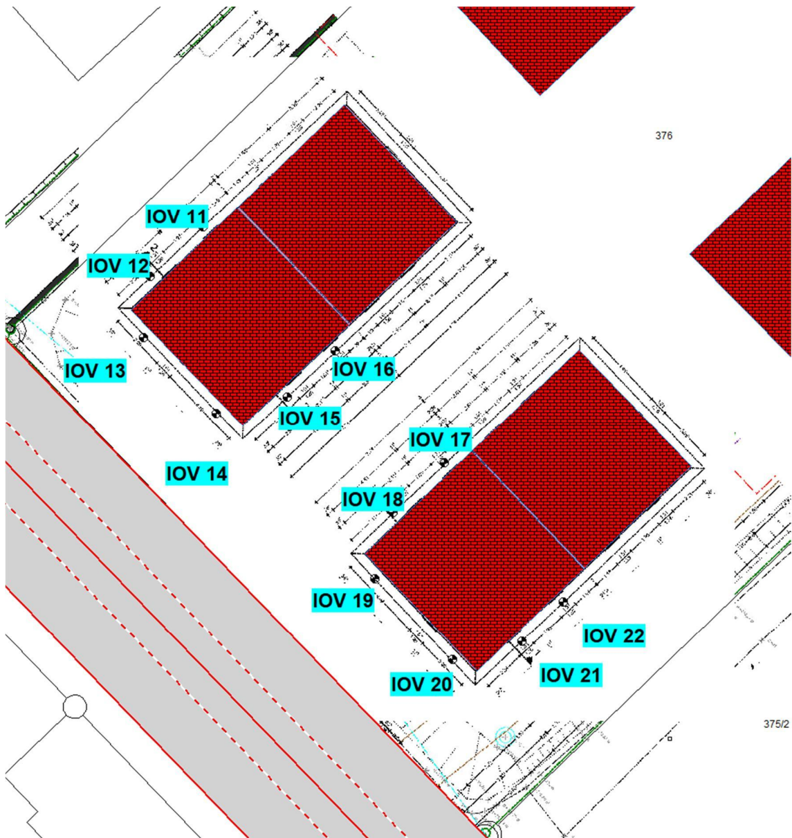
Abbildung 2.3: Lageplan mit Kennzeichnung der Immissionsorte IOV 11 – IOG 22 – Verkehr Obergeschoss
